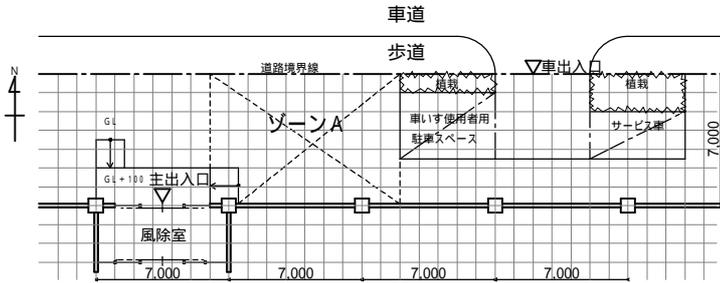
3. 下図の状況において、地下1階に約200㎡の機械室がある場合、メンテナンスを目的としたドライエリアを記入せよ。
